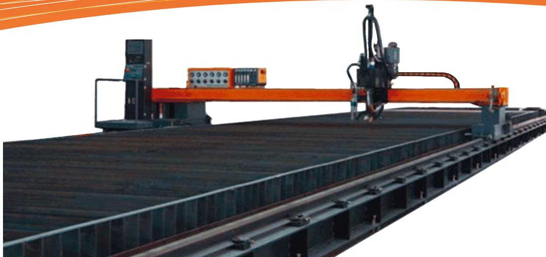
La gama de pantógrafos de corte Plasmacut Powerful son máquinas de diseño modular con estructura tipo pórtico de puente móvil y mesa independiente para cargas pesadas con sistema de aspiración selectorizado y armazón convertible para zonas de corte sumergido.
